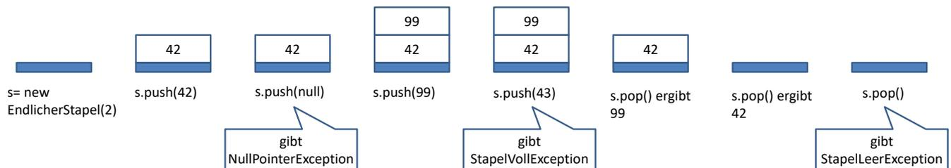
Ein Stapel (Stack) ist eine Datenstruktur, die Objekte eines bestimmten Typs aufnehmen kann. Dabei werden Objekte mit einer Methode `push(.)` so auf den Stapel gelegt, dass das neue Element immer oben liegt. Mit der Methode `pop(.)` wird das oberste Element zurückgegeben und vom Stapel gelöscht. Weiterhin ist es sinnvoll, wenn es Methoden `istLeer()` bzw. `istVoll()` gibt, mit denen man prüfen kann, ob ein Stapel voll oder leer ist.
